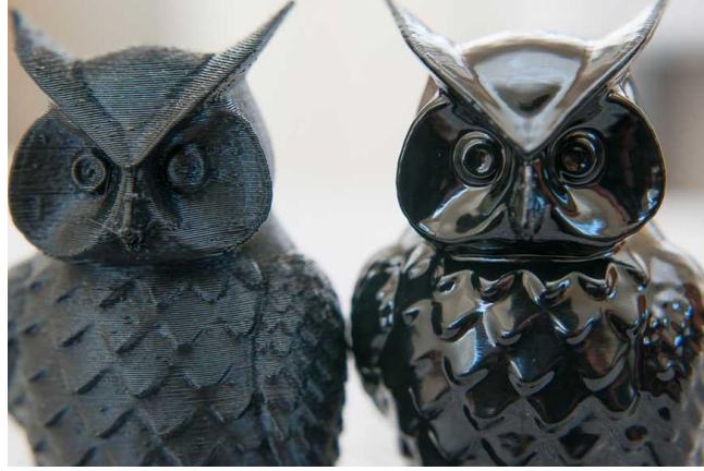
Şekil 10 – Buhar yumuşatmadan önce ve sonra 3D yazdırılmış bir nesne. Kaynak: www.geeetech.com
